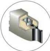
**Núcleo Aislado** – El núcleo de uretano espumado en su lugar sin clorofluorocarbonos (unido permanentemente a la superficie exterior) no se rompe cuando sufre un impacto, proporciona control del ruido y un aislamiento excelente con un factor R de 10.83.
